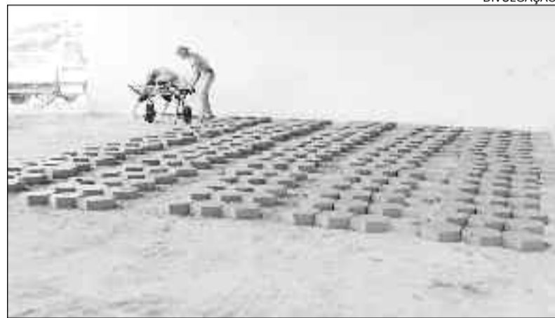
Servidores trabalham na produção de bloquetes de cimento: obras
